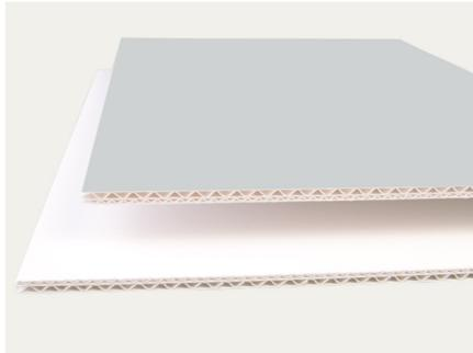
**Beschreibung:** Doppelte Wellpappe aus alterungsbeständigem, naturweißem Karton. Wellenhöhe 3,0 und 1,5 mm, Gesamtdicke 4,5 mm.
