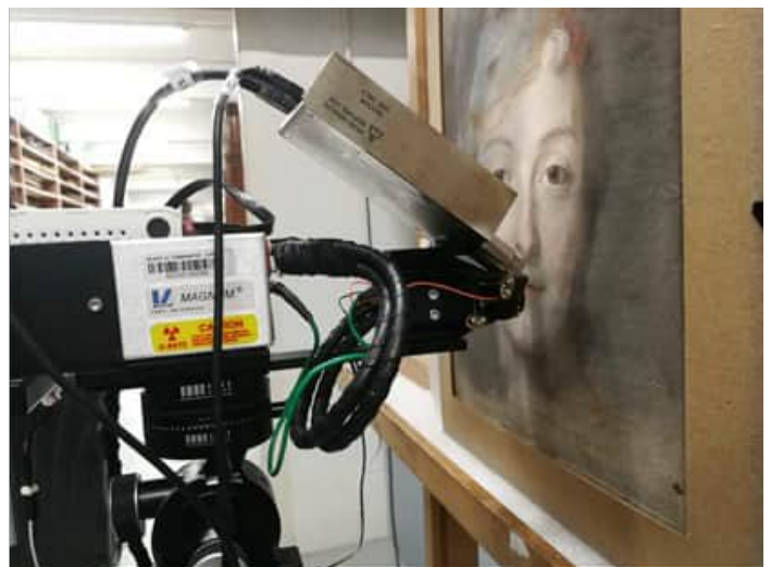
Fig. 2 Portable X-ray fluorescence spectroscopy (non-contact) on Mme Fel, La Tour, LT4, Musée A. Lécuyer (© CNRS-LAMS)
